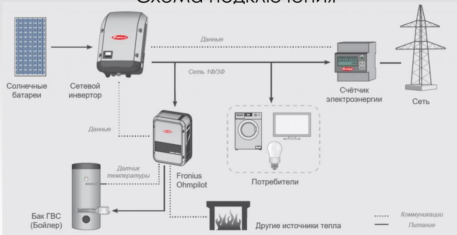
**Fronius Ohmpilot** информационно соединяется с установленным в системе счетчиком **Fronius smart meter** и даталогером сетевого инвертора, и когда он видит что есть избыток электроэнергии, который не используется на самопотребление, он автоматически включает бойлер для нагрева воды. Широкие возможности работы **Fronius Ohmpilot** позволяют ему включать нагрузку от 300 Вт до 9 кВт. Также на одно устройство можно подключить от одного до трех однофазных 3 кВт ТЕНов.
