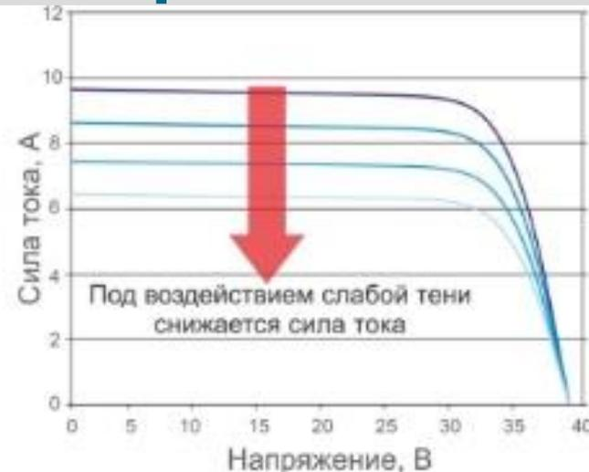
Даже незначительное затенение одного фотоэлемента в солнечной батарее приводит к серьезному снижению генерации электроэнергии всей солнечной станции. Чтобы избежать сильного падения эффективности, в солнечные батареи встраивают шунтирующие диоды, еще их называют байпасными диодами.
